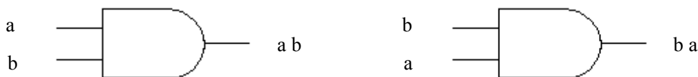
Figuur 6 Commutatieve wet voor de Booleaanse vermenigvuldiging aan de hand van de hardware implementatie.
