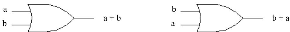
Figuur 5 Commutatieve wet voor de Booleaanse optelling aan de hand van de hardware implementatie.
